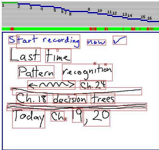
FIG. 4 – Un algorithme regroupe les notes en utilisant le temps. Les pen-stroke qui ont été faits à un moment proche seront regroupés.
