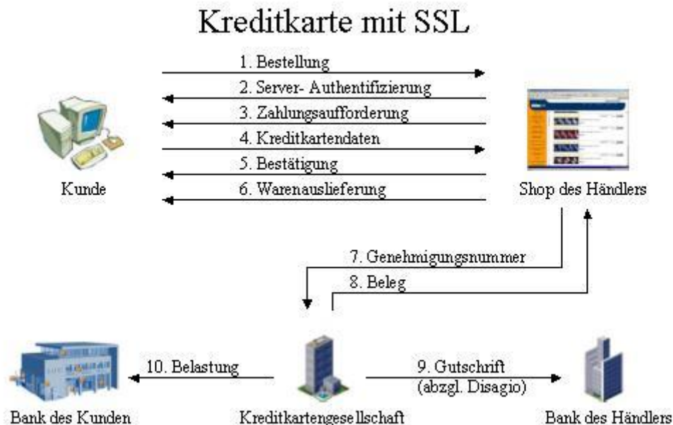
Abbildung 6: Ablaufdiagramm des Kreditkartenverfahrens mit SSL
